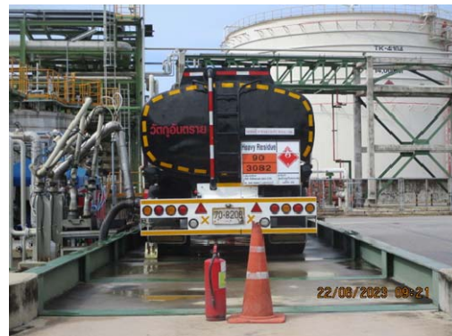
รูปที่ 3.2-41 ป้ายแสดงชนิดของสารที่ขนส่ง และสัญลักษณ์ความปลอดภัยที่รถขนส่ง
