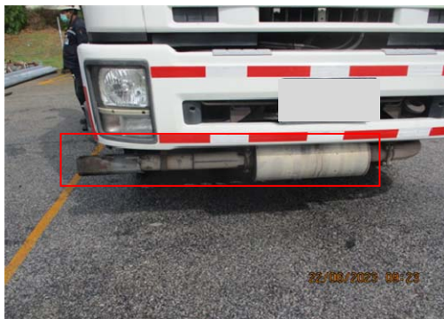
รูปที่ 3.2-48 อุปกรณ์ป้องกันประกายไฟที่ท่อไอเสีย
